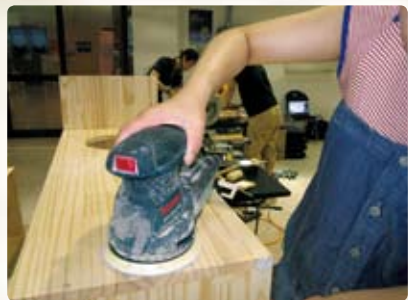
5 나사못 박은 자리에 나무못을 박고 평평하게 잘라내어 표면을 깔끔하게 한 다음, 표면을 사포로 정리한다.
